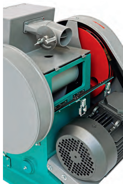
Патрубок для подключения БПУ (системы пылеудаления с шиббером) в зоне загрузки ЩД 10М
