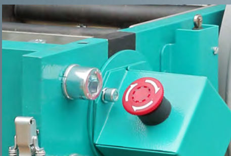
Аварийная стоп-кнопка и концевой микровыключатель ЩД 15
