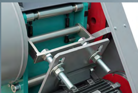
Устройство регулировки натяжения ременной передачи дробилки ЩД 15
