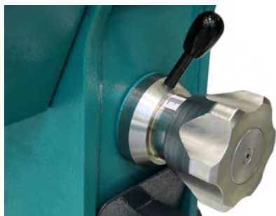
Устройство регулировки зазора между щеками со шкалой
